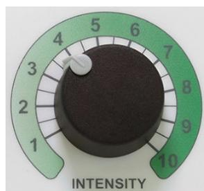
Pour régler la puissance de sortie, utiliser le régulateur de puissance (7). Le réglage de la puissance s'effectue d'une valeur minimale prédéterminée jusqu'à une valeur maximale, en fonction de la forme de courant sélectionnée (voir chapitre 9.1). La puissance de sortie augmente alors de façon presque linéaire avec l'angle de rotation. Le rapport pour chaque type de courant est disponible dans les diagrammes ci-dessous.
