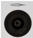
Pour la coagulation bipolaire, un câble de raccordement pour instruments est branché sur la prise (20). Plusieurs instruments bipolaires peuvent être raccordés à ce câble.
