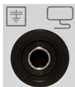
Brancher l'électrode neutre au raccord (14). Raccorder au choix des électrodes neutres en une seule unité ou des électrodes neutres en deux parties permettant un contrôle du contact avec les patients.
