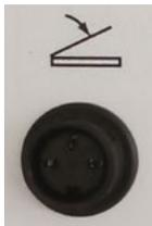
Pour la coagulation bipolaire, l'électrode neutre **ne doit pas** être raccordée.
