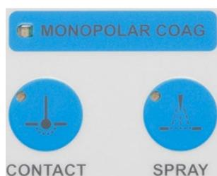
Sur le panneau de commande marqué en bleu "Monopolar COAG" de la face avant, un témoin (5) d'activation du courant de coagulation monopolaire est affiché. Deux types de courants sont disponibles pour la coagulation.
