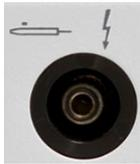
Pour la coupe et la coagulation monopolaires, une poignée avec une commande au doigt ou une poignée sans commande au doigt en combinaison avec une commande au pied peut être raccordée. Les poignées sont branchées au raccord (10). Insérer l'électrode active souhaitée dans la poignée chirurgicale jusqu'à ce qu'un maintien sûr soit obtenu.
