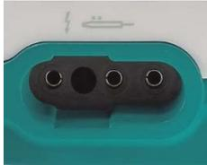
Raccordement des **poignées monopolaires avec commutateur digital**, par ex. accessoires Sutter REF 36 07 04 :
