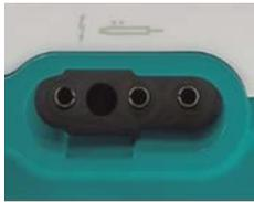
Raccordement des **poignées monopolaires sans commutateur digital**, par ex. accessoires Sutter REF 36 02 14 :
