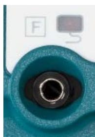
Raccorder l'électrode neutre sur la face avant de l'appareil, au niveau de la prise de raccordement (30). Raccorder au choix des électrodes neutres en une seule unité ou des électrodes neutres en deux parties permettant un contrôle du contact avec les patients.
