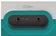
La mise en service d'**instruments bipolaires** sans commutateur digital se fait en insérant le câble de raccordement dans la douille (23) située sur la partie avant de l'appareil **et** en raccordant le commutateur à pédale (REF 36 01 10) à la douille (38) située au dos de l'appareil (voir schéma en bas à gauche).
