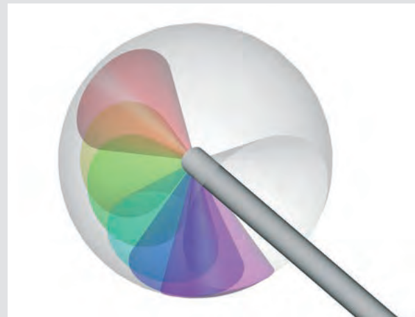
ENDOCAMELEON® à direction de visée variable, vue isométrique
