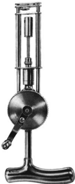
PERFORATEUR A MAIN TELESCOPIQUE KM 48-440 300 mm avec guide-foret, étrier d'accouplement et mandrin et clé engrenages chromés poignée en acier inoxydable
