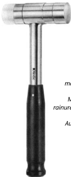
MAILLET REPROCUSSION KM 46-690 292 mm poids : 600 g poids tête : 285 g diamètre tête : 32 mm maillet sans rebond avec manche phénolique, un embout en nylon, et un côté en acier inoxydable
